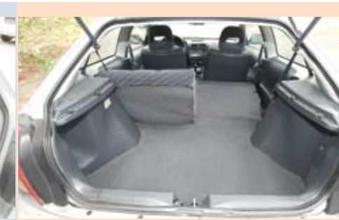
A Honda rakterébe belógnak a hátsó felfüggesztések
